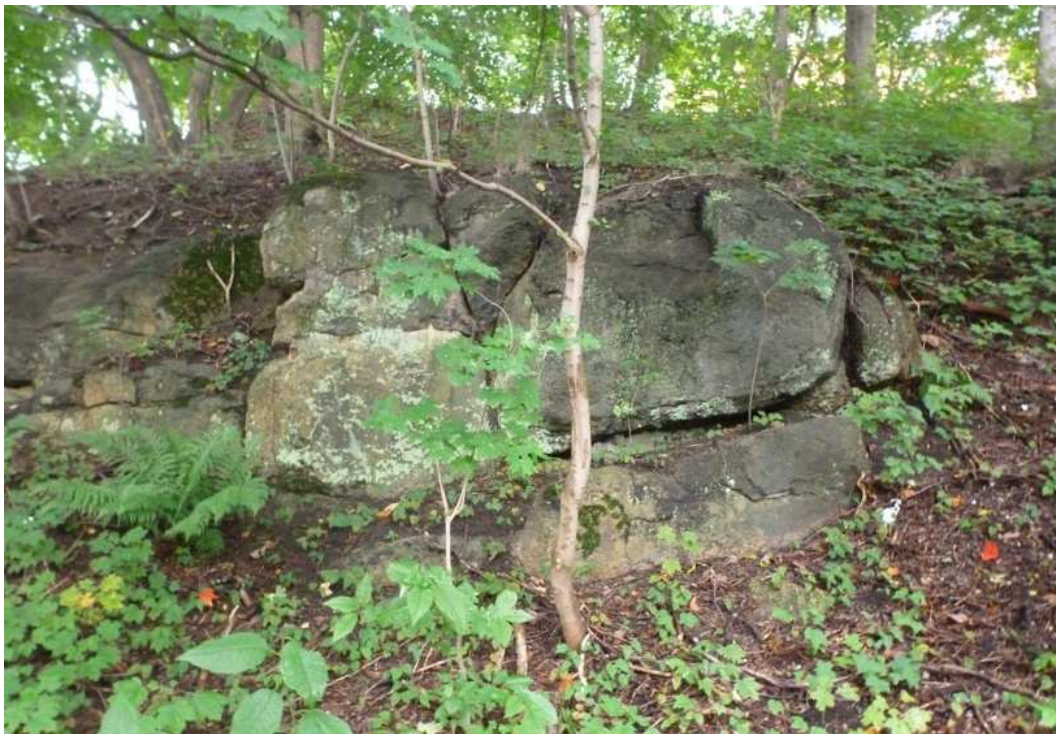
Kvádrovitá odlučnost nestabilních žulových bloků. Bude lokálně kotveno.
