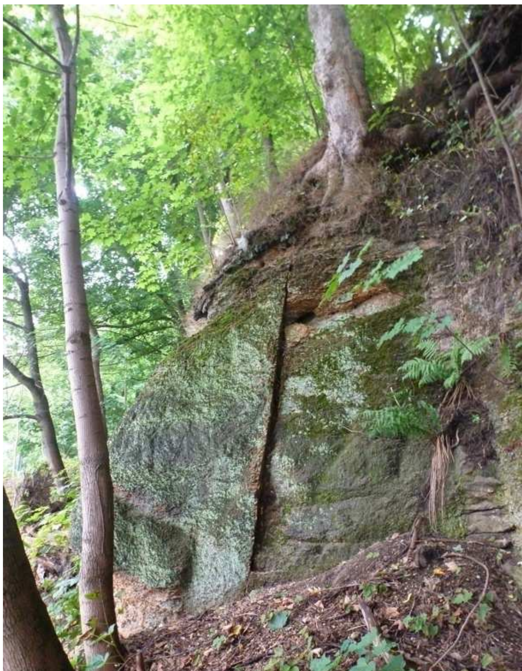
Nestabilní, zcela oddělený žulový blok, který bude odtěžen. Jednou z příčin je i kořenový systém stromu nad ním. Vlevo dole je patrná jeho oslabená podstava.
